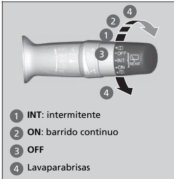
El limpiacristal/lavaparabrisas trasero se puede utilizar cuando el modo de alimentación está en la posición de CONTACTO.
