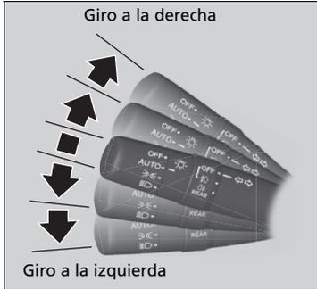
Los intermitentes se pueden utilizar cuando el sistema de alimentación está en la posición de CONTACTO.
