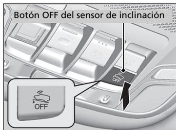
Para apagar el sistema de sensor de inclinación, pulse el botón OFF correspondiente después de establecer el modo de alimentación en ACCESORIOS o VEHÍCULO APAGADO (BLOQUEO).
