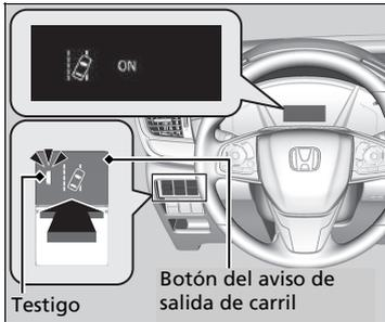
Pulse el botón del sistema de aviso de salida de carril para encender y apagar el sistema.
