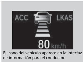
Cuando delante de usted se detecta un vehículo a menor velocidad que la que usted ha programado, su vehículo empieza a disminuir la velocidad.
