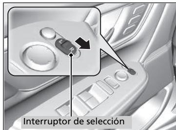
Si está activada esta función, el retrovisor del pasajero se inclina automáticamente hacia abajo cuando se coloca la transmisión en la posición **R**. Esta función mejora la visibilidad en el lado del pasajero al dar marcha atrás. El retrovisor regresa automáticamente a su posición original cuando la transmisión se cambia a una posición distinta a **R**.
