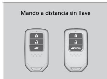
Utilice las llaves para encender y apagar el sistema de alimentación, así como para bloquear y desbloquear todas las puertas y el portón trasero. También puede utilizar el mando a distancia para bloquear y desbloquear todas las puertas y el portón trasero.
