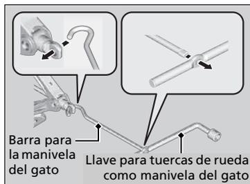
7. Coloque el gato debajo del punto de apoyo más cercano al neumático que va a cambiarse.
