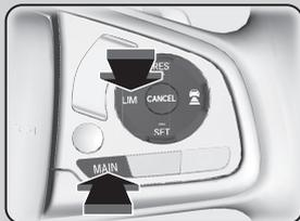
Si se enciende un testigo diferente, pulse el botón **LIM** para cambiar al limitador de velocidad ajustable.
