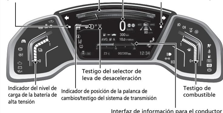
Indicador del nivel de carga de la batería de alta tensión
