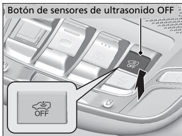
Para apagar el sistema de sensor de ultrasonido, pulse el botón OFF correspondiente después de establecer el modo de alimentación en ACCESORIOS o VEHÍCULO APAGADO (BLOQUEO).
